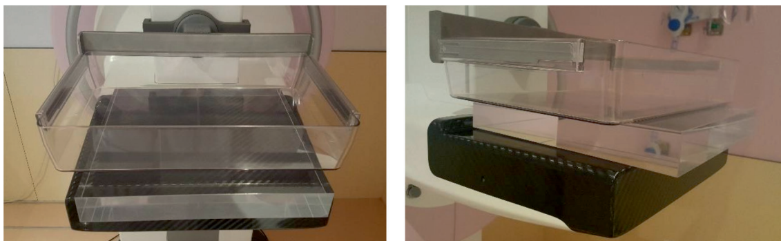
Fig. 2.7. Disposición del bloque de PMMA y la pala compresora para la adquisición de imágenes para medir la uniformidad.
