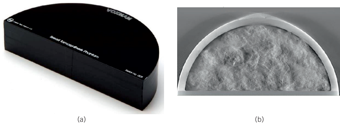
Fig. 3.5. (a) Maniquí VOXMAN de 4,5 cm de espesor; (b) Plano reconstruido obtenido con un sistema de tomosíntesis de mama mostrando la textura del material que rellena el maniquí. (Adaptado de https://www.leedstestobjects.com/ ).
