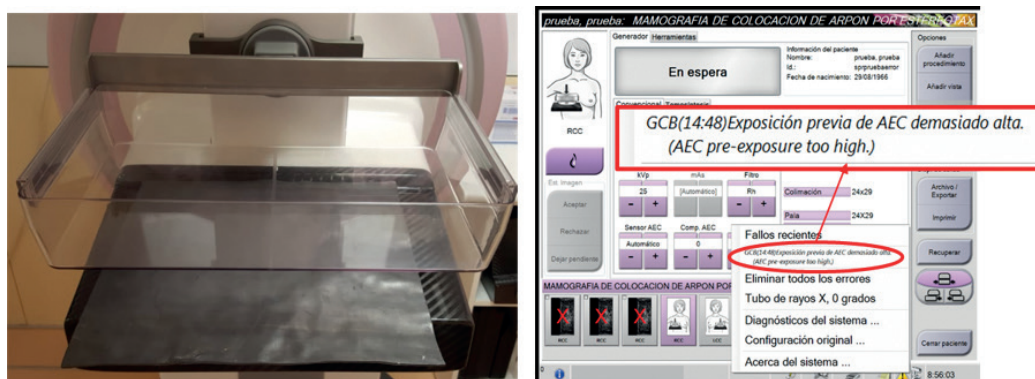
Fig. 2.3. Placa de plomo sobre el detector y compresor a una altura de 5,3 cm (izquierda); Ejemplo de mensaje de error que aparece en la consola del equipo (derecha).
