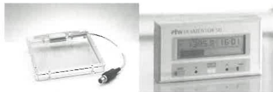
Figura 3. Ejemplo de cámara de transmisión para medidas del producto dosis-área y unidad de lectura.
